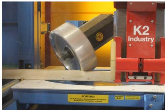
Die 5-Achs-Universalfräse ermöglicht einen schnellen Arbeitsfortschritt, da das Holz seltener umgekantert werden muss
