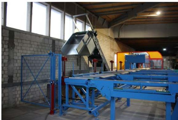
Zusammen mit der neuen Anlage wurde ein Fördersystem zum automatischen Abtransport von Spänen und Holzklötzen installiert
