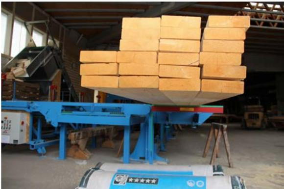
Vorderwisch mit zwei Fingerfräsern und vier Bohraggregaten ausgerüstet. Außerdem verfügt sie über ein Schlitzaggregat. Für die Beschriftung von Holzbauteilen ist die Anlage mit Markiergeräten mit Markierstiften und einem eingebauten „Inkjet 4“-Tintenstrahldrucker ausgestattet.
