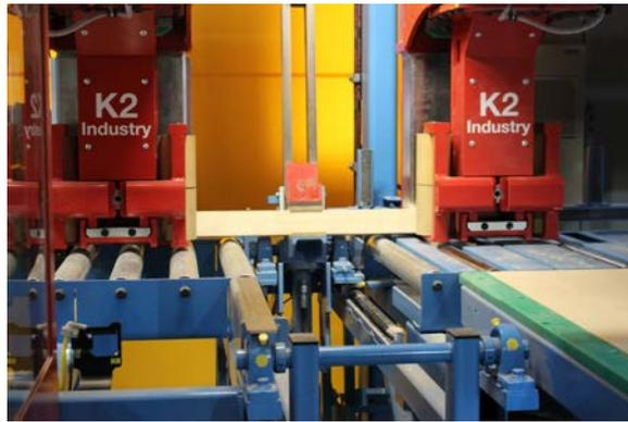
In der Anlage werden Holzbalken mit zwei Greif- und Führungswagen schonend fixiert und transportiert
