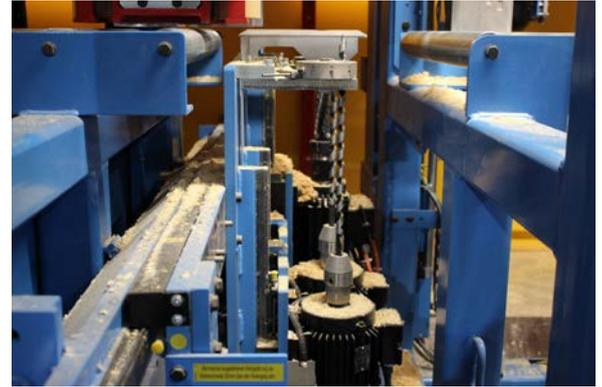
Auf dem hydraulischen Hubtisch an der Maschine (rechts im Bild) können Holzpakete aufgesetzt und auf die gewünschte Höhe gehoben werden
