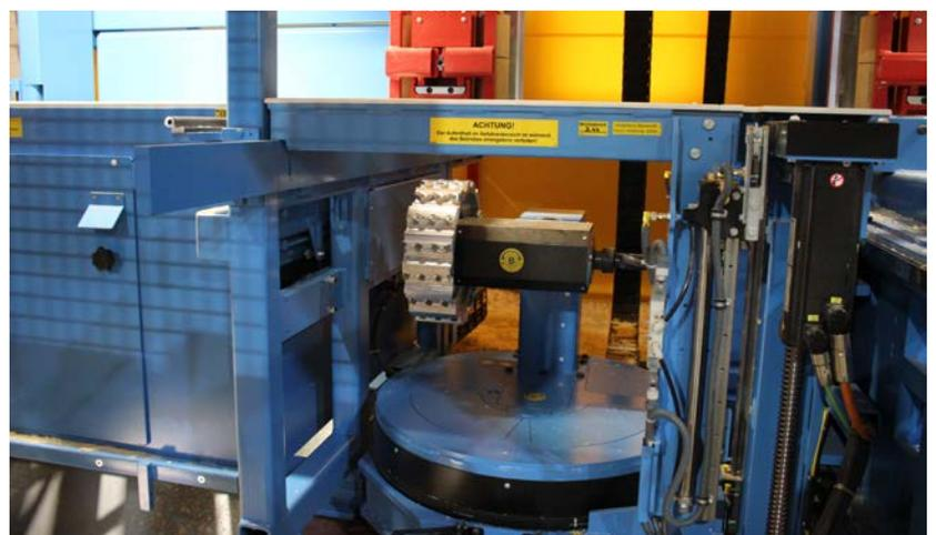
Die neue Abbundanlage bei Holzbau Vorderwisch ist mit vier Schlangenbohrern ausgerüstet. Davon sind zwei horizontal angeordnet ...
