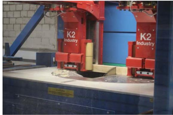
Die neue Abbundanlage ist mit einem 13 kW-Sägeaggregat ausgestattet. Abgesägte Holzstücke werden über den halbseitig offenen Säge Tisch entsorgt
