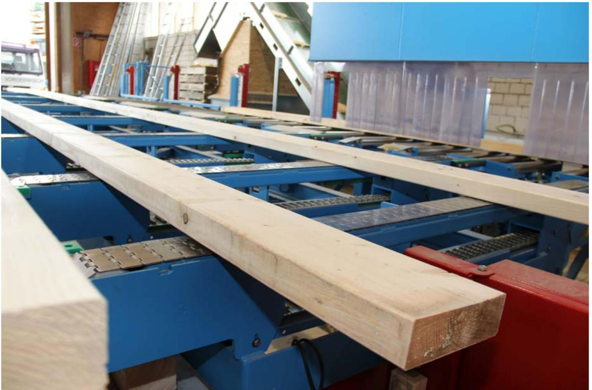
Wunsch des Holzbaubetriebs ist die Abbundmaschine mit einem weiteren Extra ausgestattet: Die Balken werden vor der Bearbeitung auf einem hydraulischen Hublift abgelegt und dann auf die Höhe der Anlage gehoben – eine ergonomische Entlastung für die Mitarbeiter. Vom Hublift aus werden die Hölzer einzeln und automatisch der Anlage zugeführt.
