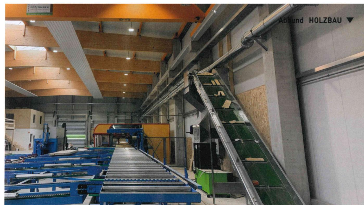
Förderband mit einer Länge von etwa 70 m auf. Es verläuft unterhalb des Maschinenbettes der Abbundanlagen und der Industriehobelmaschine. Förderbänder sind grundsätzlich eine energieeffiziente Methode, um große Mengen Prozessabfälle zu transportieren. Sie bieten sich bei Neubauten an, da sie sich bei guter Planung sehr gut in die Abläufe integrieren lassen. Am Ende des Förderbandes arbeitet ein Restholzzerkleinerer, der die Abschnitte förderfähig aufbereitet.
