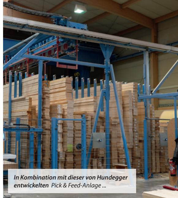
In Kombination mit dieser von Hundegger entwickelten Pick & Feed-Anlage ...
