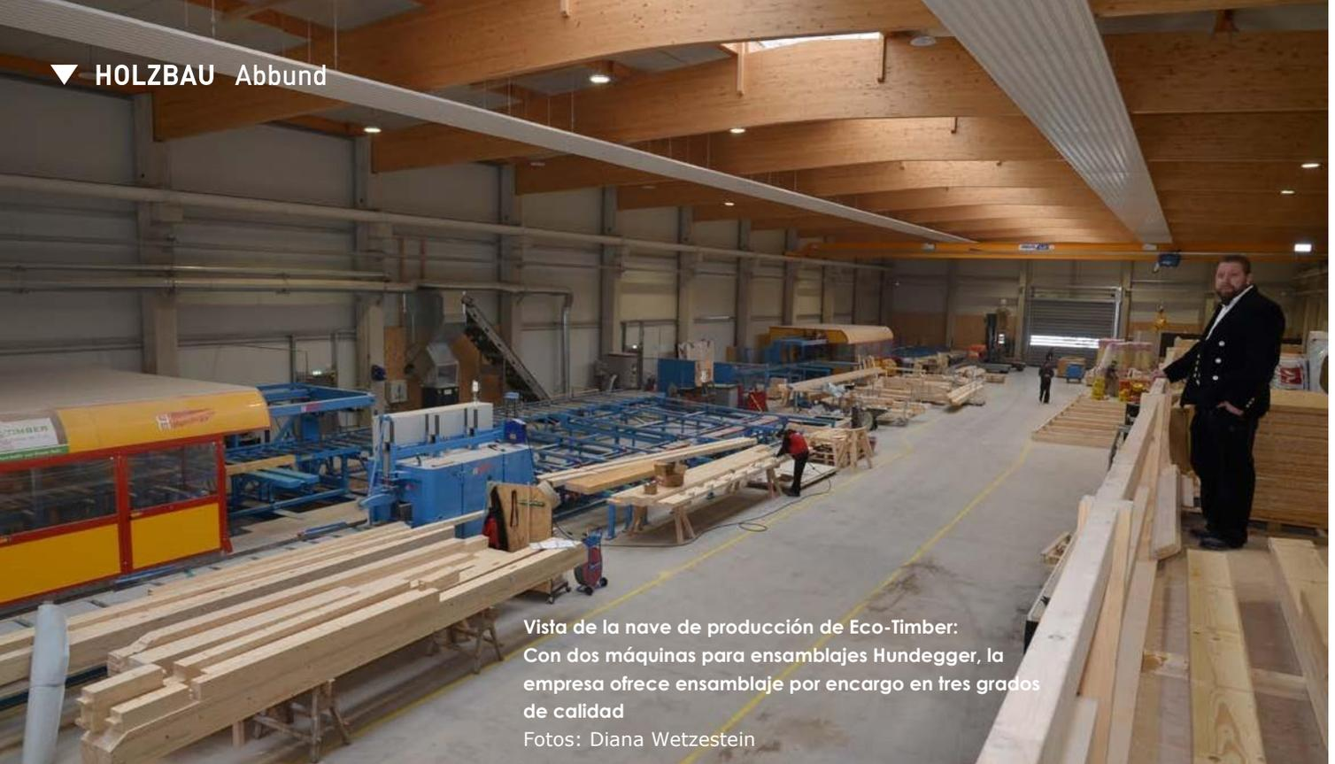
Vista de la nave de producción de Eco-Timber: Con dos máquinas para ensamblajes Hundegger, la empresa ofrece ensamblaje por encargo en tres grados de calidad
