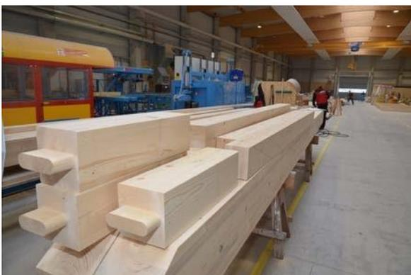
Sus empleados fabrican con dos máquinas Hundegger "K2 Industry" pueden utilizarse tanto para ensamblado sencillo y de bajo coste como para el ensamblado profesional con muescas y revestimientos sin desgarros. Con un postprocesamiento manual, alcanzan incluso el tercer grado de calidad "Ensamblaje vista plus", en el que se prepara la óptica visual de la madera. Todas las huellas de mecanizado de la madera se eliminan en la fase de máxima calidad con el cepillado por las cuatro caras.
