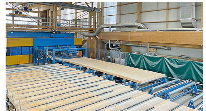
**Una volta completata la lavorazione,** gli elementi X-Lam possono essere ulteriormente nobilitati sul trasportatore trasversale
