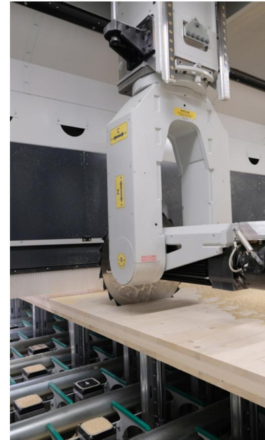
Die luftgekühlte Hochleistungsspindel sorgt für die nötige Zerspanungsleistung
