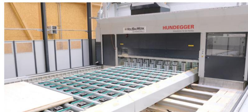
Das simultane Ein- und Ausfahren der Platte spart Zeit. Die Vakuumstempel werden beim Ausfahren der Platte Reihe für Reihe abgesenkt und automatisch gereinigt
