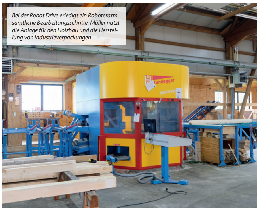
Andreas Müller fühlt sich in seiner Hundegger sichtlich wohl. Der Roboterarm kann auf bis zu 18 Werkzeuge zugreifen
