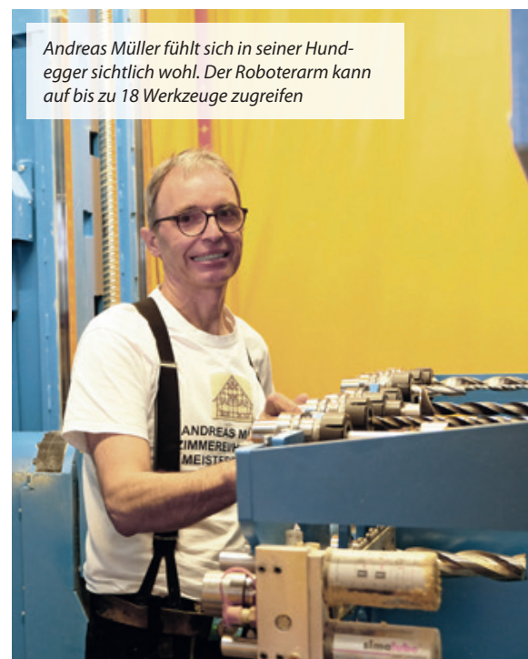
Fräsen, bohren, schneiden: Die Anlage erledigt alle Bearbeitungsschritte in einem Arbeitsgang
