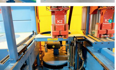
1 Depuis l'automne 2020, la scierie et raboterie Ströbitzer offre également le taillage de charpente à façon. L'usinage à commande numérique complètement automatique est réalisé sur cette K2-Industry de Hundegger
