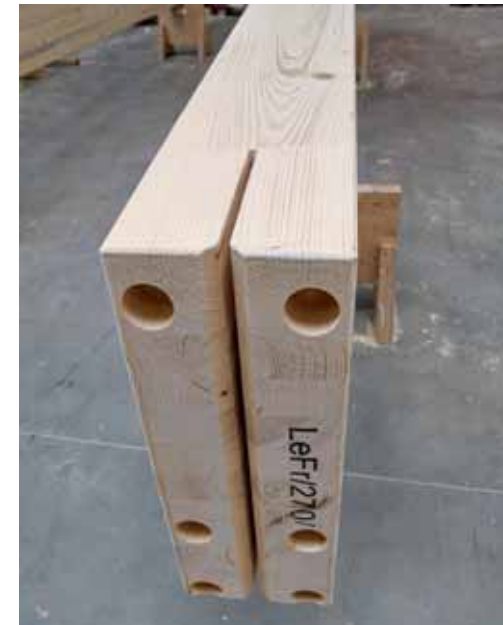
Laut den Erfahrungen bei X-Cam arbeitet die Horizontalsäge sauberer als ein Standard-Schlitzgerät. (Foto: X-Cam)
