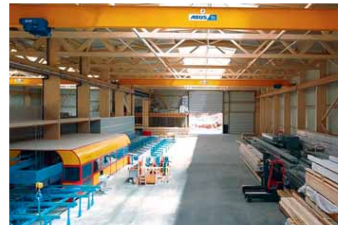
Oben: In Kall können bis zu 30 m lange Bauteile abgebunden werden. Links unten in Hallenmitte die Abbundanlage. (Foto: X-Cam)
