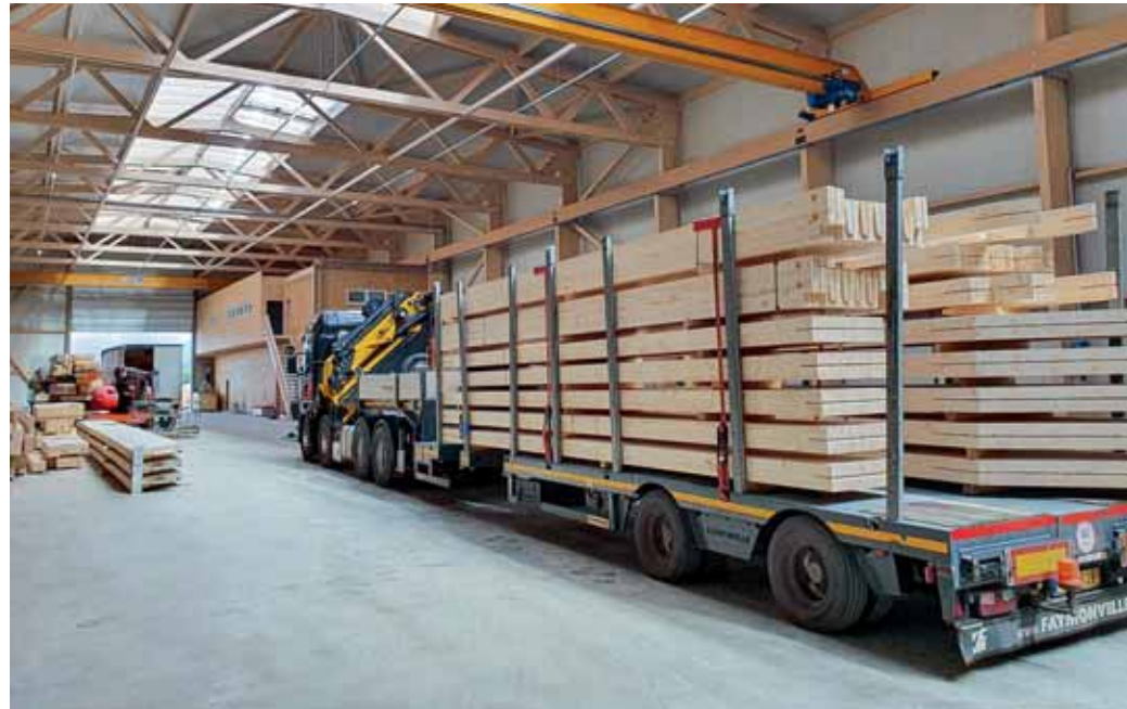
Die Bausätze werden so verladen, dass die Elemente in der richtigen Montage-Reihenfolge ankommen. (Foto: X-Cam)
