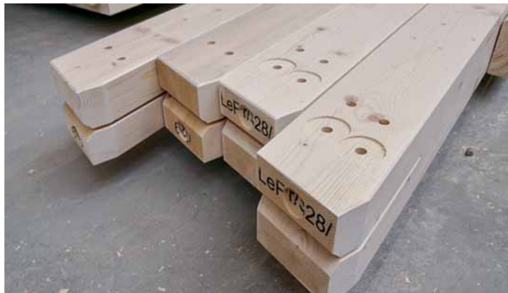
Das Tintenmarkiersystem erleichtert die Montage auf der Baustelle (Foto: St. Klein)
