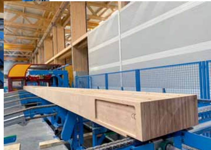
Das Robot-Aggregat bearbeitet auch Elemente aus Hartholz, wie z.B. diesen Träger aus Buchen-Furnierschichtholz. (Foto: X-Cam)
