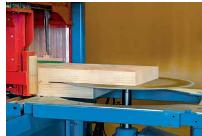
Die Horizontalsäge der Abbundanlage hat ein 900mm-Blatt (Foto: Hundegger)
