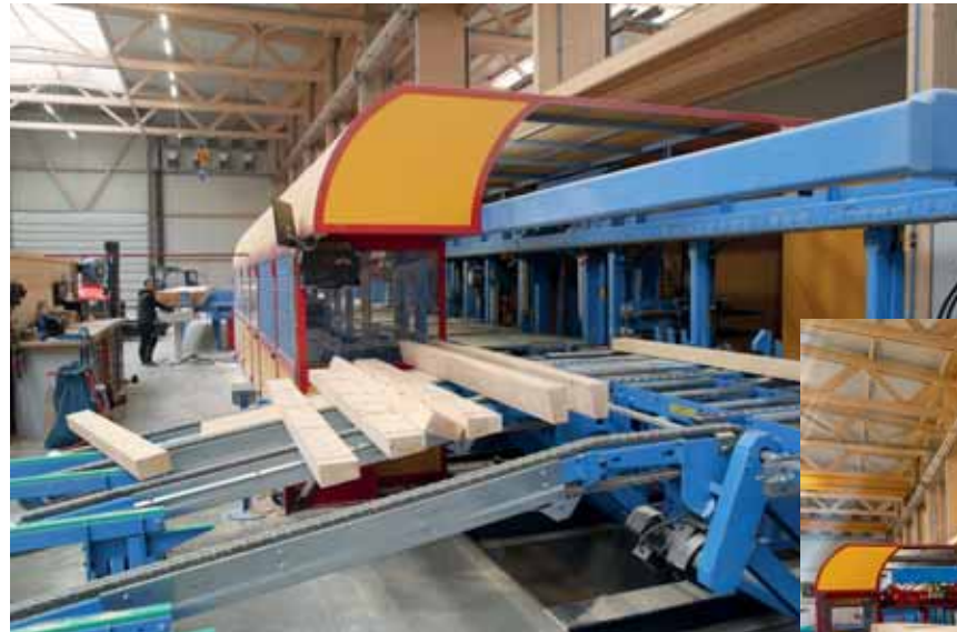
Das Robot-Aggregat bearbeitet auch Elemente aus Hartholz, wie z.B. diesen Träger aus Buchen-Furnierschichtholz. (Foto: X-Cam)
