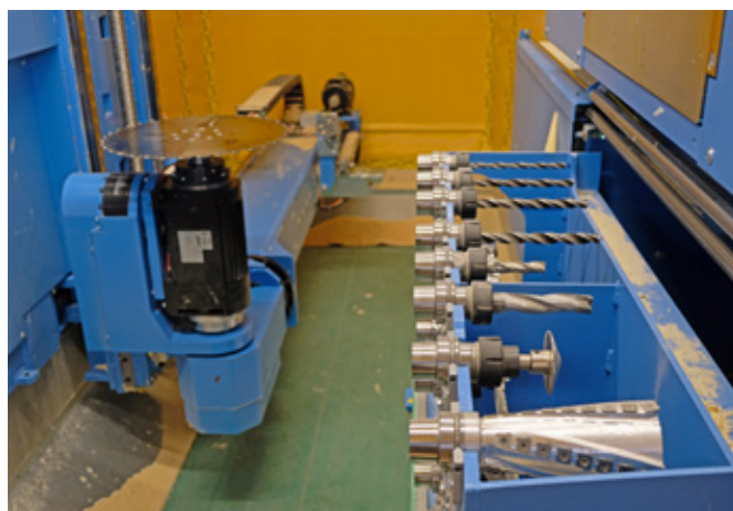
Ein Werkzeugwechsler mit 18 Plätzen bietet ausreichend Platz für alle Fräs-, Bohr- und Sägewerkzeuge
