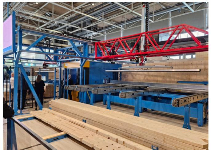
Eine Fertigungszelle mit automatischer Beschickung und Paketbildung ermöglicht einen mannlosen CNC-Abbbund
