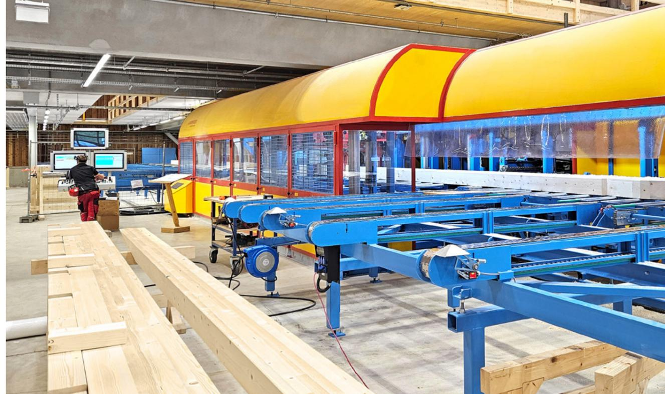
Bei Theurl werden die K2-Industry-Anlagen von Hundegger automatisch beschickt und sind damit optimal ausgelastet
