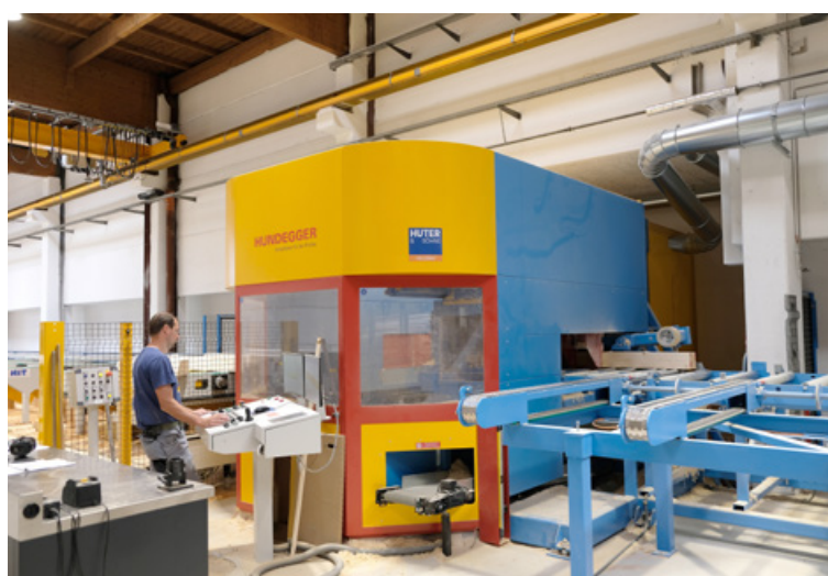
Huter & Söhne entschied sich für die große Ausführung der Robot Drive mit 1300 mm Bearbeitungsbreite
