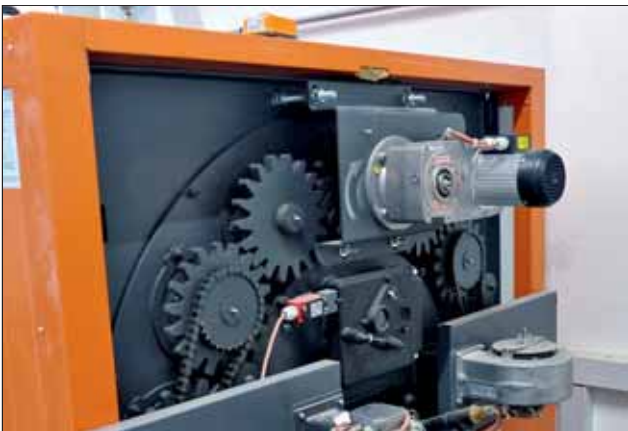
Das Bild zeigt die Mechanik, die die Bürsten zur automatischen Reinigung der Züge antreibt.
