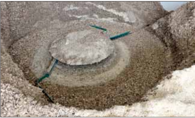
Höhle setzte bei seiner Hackschnitzelaustragung auf eine robuste Gelenkarmaustragung mit Schnecke.
