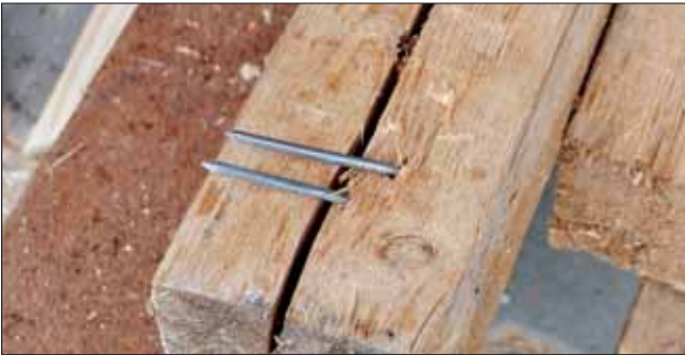
Im als Brennstoff genutzten Restholz von den Baustellen befinden sich oft Nägel oder Schrauben, ...
