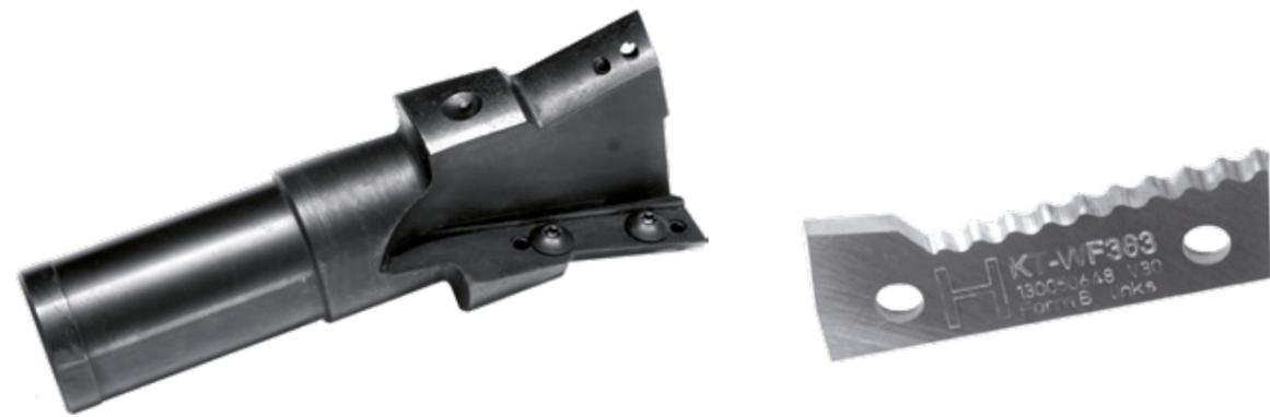
Schwalbenschwanzfräser mit Wechselmesser
